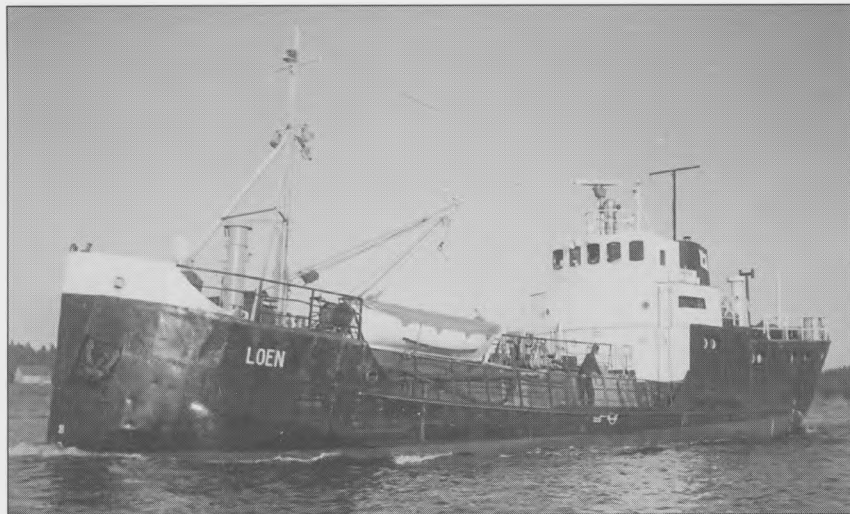
Motortankeren Loen trafikkerte vestlandskysten og Oslofjorden under L'Orsas flagg en tiårsperiode fra 1965. Her er den fotografert etter at baugen ble avkortet for fart på Telemarkskanalen. Den ble senere ombygd til flytedokk, og eksisterer i dag som husbåt. Foto via rederiet.
