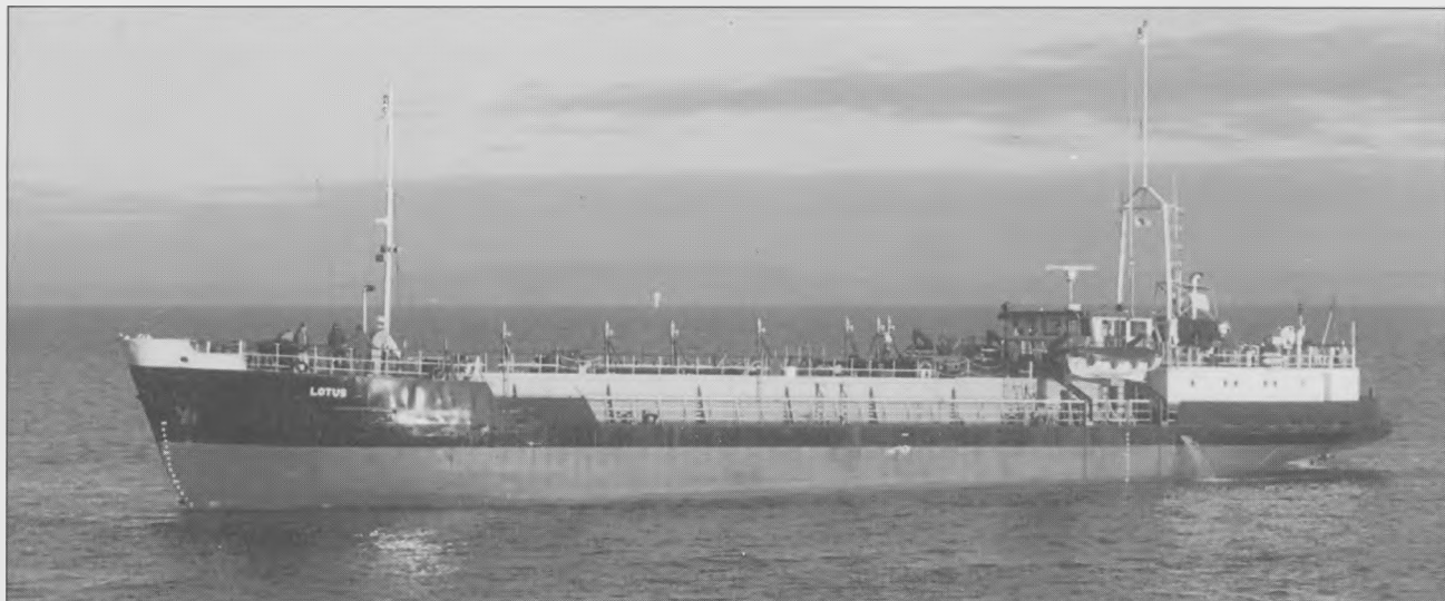
Motortankeren Lotus ble innkjøpt fra Storbritannia i 1995. Den er på 1065 dødvektstonn, og trafikkerer Oslofjorden med avstikkere på Nord- og Østersjøen. Foto via rederiet.
