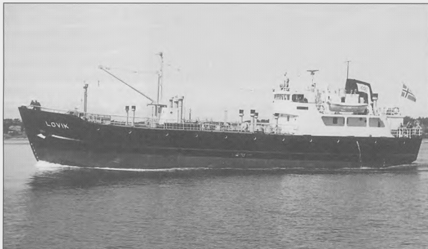
Lovik fotografert rett etter levering i juli 1966. Den var enestående for sin tid med blant annet to Schottel azimuth-thrustere til fremdrift og E0-klasset maskineri. Båten går i dag i fart mellom greske øyer for en lokal operatør. Foto via rederiet.
