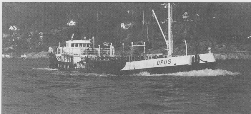
Motortankeren Hestia av Stavanger ble overtatt av L'Orsa og bygget om til lekteren Opus ved Mågerø Verft. Foto via rederiet.
